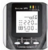
Display funcional para ser utilizado en 2 posiciones
